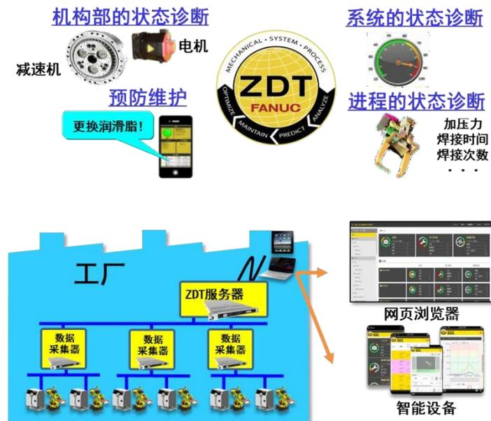
图 4 维护诊断系统 ZDT
